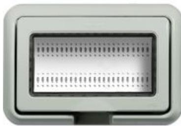
coperchio IP55 per installazione incassata in scatola 504E di 4 moduli LivingLight o Luna - colore grigio RAL7035. Nota: il grado di protezione IP55 si ottiene a coperchio chiuso e con articolo installato su pareti lisce, senza scanalature ed impermeabili (piastrelle lisce, marmo)
