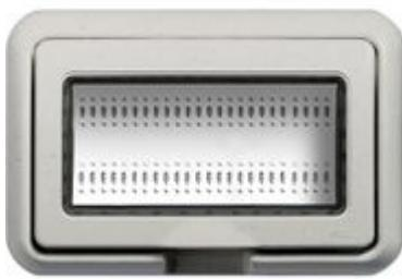
coperchio IP55 per installazione incassata in scatola 504E di 4 moduli LivingLight o Luna - colore bianco. Nota: il grado di protezione IP55 si ottiene a coperchio chiuso e con articolo installato su pareti lisce, senza scanalature ed impermeabili (piastrelle lisce, marmo)
