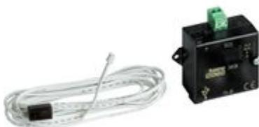
Interfaccia con emettitore IR per apprendere e riprodurre il segnale IR di telecomandi per climatizzatori. Controllabile da Touch Screen e Multimedia Touch Screen. Contenitore Basic per l'installazione dietro il climatizzatore. Lunghezza cavo IR 2 m, alimentazione da bus 27 V.
