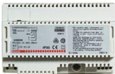
Alimentatore per impianti audio e video 2 FILI in custodia modulare 8 DIN. Alimentazione 230 V.a.c. 50-60 Hz. Fornisce in uscita una bassa tensione continua a 27 Vd.c. con una corrente max di 1,2 A ed è protetto elettronicamente (senza fusibile) contro il cortocircuito ed il sovraccarico. E' un dispositivo di sicurezza a doppio isolamento SELV
