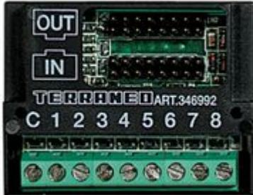
Modulo espansore per collegare più di 8 tasti di chiamata al gruppo fonico universale 346991. È possibile collegarne fino a 6 per un totale di 56 chiamate in impianti con alimentatore 346000 / 346050. Massimo 2 moduli per un totale di 24 chiamate in impianti con alimentatore audio 346040.
