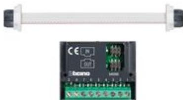
Modulo espansore tasti Sfera. Consente di collegare tasti di chiamata ai moduli fonici Sfera (351000, 351100, 351500, 351200, 351300) e al gruppo fonico universale (346994). Ogni modulo può gestire fino a 8 tasti di chiamata. È possibile collegare più moduli espansione tasti (max 96 tasti di chiamata per posto esterno).
