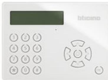
Tastiera multifunzione con display LCD, tasti meccanici, lettore di prossimità per transponder art. 34820.... Può essere impiegata per la programmazione dei parametri della centrale. Montaggio in scatola art. 503 e in scatole da incasso tonde con interasse 60mm. Colore bianco.
