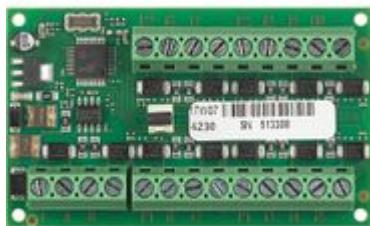
Modulo di espansione per aggiungere alla centrale un massimo di 10 ingressi 500mA-12Vdc programmabili.
