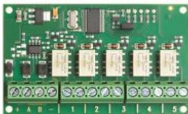
Modulo di espansione relè per aggiungere alla centrale un massimo di 5 uscite relè programmabili da 1A. Completo di 4 supporti per il montaggio.
