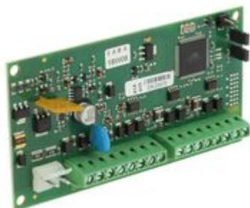
Stazione di alimentazione supervisionata che consente di rialimentare e replicare il BUS antifurto estendendolo su due rami aggiuntivi. L'alimentazione alle due nuove tratte è fornita tramite il dispositivo stesso, protetto da un fusibile termico autoripristinante da 1,5A e collegato agli alimentatori presenti nei contenitori art. 4210 e art. 4211.
