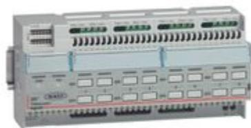
Attuatore dimmer in tecnologia BUS-SCS 1/10V, tecnologia “Zero Crossing”, 4 uscite di carico massimo 4,3 A a 230 V a.c., connessione a morsetto, grado di protezione IP20, 10 moduli DIN, alimentazione 100/240 V a.c. 50/60 Hz, pulsante per la procedura Push&Learn, pulsanti per il comando diretto del carico.
