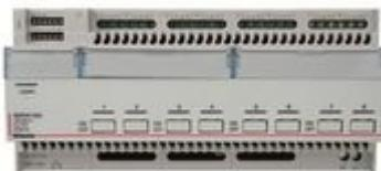
Attuatore BUS-SCS ON/OFF, tecnologia “Zero Crossing”, 8 uscite indipendenti di carico massimo 16 A a 230 V a.c., connessione a morsetto, grado di protezione IP20, 10 moduli DIN, alimentazione 100/240 V a.c. 50/60 Hz, pulsante per la procedura Push&Learn, pulsanti per il comando diretto del carico.
