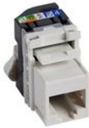
Connettori RJ45 con attacco universale keystone - connessione ad incisione d'isolante senza di attrezzi - per cavo U/UTP 22÷24 AWG a 4 coppie 100? - conforme alla normativa EN 50173-1 e EIA/TIA 568 A/B - non installabile su pannelli di permutazione - colore bianco
