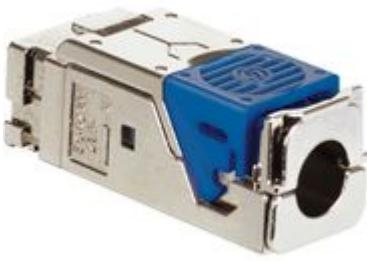
6 connettori RJ 45 CAT 6 STP con sistema Quick Connect, connessione ad incisione d'isolante veloce e senza attrezzi. Conforme alla normativa ISO /IEC 11801 edizione 3.0 (2017) e EIA/TIA 568 C2-1. Da installare nei blocchi estraibili dei pannelli di permutazione quick connect. Insallabili solo su pannelli di tipo Quick Connect.
