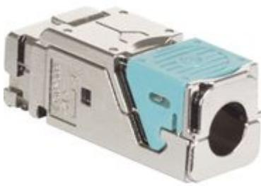
6 connettori RJ 45 CAT 8 STP con sistema Quick Connect, connessione ad incisione d'isolante veloce e senza attrezzi. Conforme alla normativa ISO /IEC 11801 edizione 3.0 (2017) e EIA/TIA 568 C2-1. Da installare nei blocchi estraibili dei pannelli di permutazione quick connect. Insallabili solo su pannelli di tipo Quick Connect
