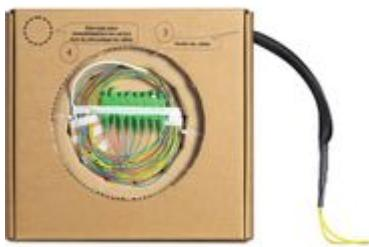
Cavo ottico (50 metri) 8 FO per antenna monomodale preterminato SC/APC. cavo ottico 8 FO per antenna, utile per la dorsale dei segnali. (cavo preconnettorizzato ad entrambe le estremità a 8 fibre: 1 antenna TV, 1 satellite, 6 fibre per ampliamento) Cavo monomodale G657A2 preterminato SC/APC.
