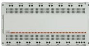
Matrice multicanale in custodia modulare 10 DIN. Predisposta per il collegamento di posti esterni videocitofonici, telecamere e sorgenti della diffusione sonora in ingresso e posti interni ed amplificatori in uscita. Quattro ingressi sono dedicati a posti esterni/telecamere e 4 alle sorgenti della diffusione sonora. Permette di realizzare impianti di diffusione sonora multicanale. Il dispositivo deve essere abbinato all'alimentatore di impianto.
