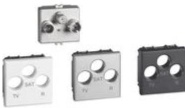
presa coassiale diretta demisecalata per impianti di antenna TV monoutenza anche telealimentati e centralizzati in derivazione, impianti via satellite monoutente e centralizzati in derivazione con passaggio di corrente e di segnale per la selezione dei canali, ed impianti radio - connettore TV maschio Ø 9,5 mm - connettore SAT tipo F e radio femmina Ø 9,5 mm - fornita in confezione con motore neutro e mostrine di finitura negli stessi colori dei meccanismi - 2 moduli
