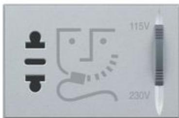
presa per rasoio con trasformatore di isolamento in 3 moduli: - tensione di ingresso 230 Va.c. 50/60 hz - tensione di uscita 115/230 Va.c. 20 VA
