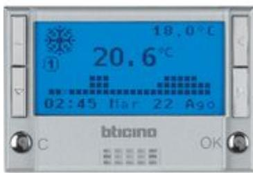
cronotermostato da incasso giornaliero/settimanale per riscaldamento e condizionamento. Tre temperature selezionabili nelle 24 h - Funzionamento auto -manuale - Holiday - antigelo. Display retroilluminato - alimentazione a batterie: 2x 1,5 V - teleattivabile attraverso controllo remoto - possibilità di collegamento di una sonda esterna - uscita: contatto in scambio 5(3) A - tech
