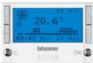
cronotermostato da incasso giornaliero/settimanale per riscaldamento e condizionamento. Tre temperature selezionabili nelle 24 h - Funzionamento auto -manuale - Holiday - antigelo. Display retroilluminato - alimentazione a batterie: 2x 1,5 V - teleattivabile attraverso controllo remoto - possibilità di collegamento di una sonda esterna - uscita: contatto in scambio 5(3) A - bianco
