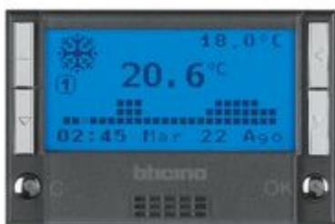
cronotermostato da incasso giornaliero/settimanale per riscaldamento e condizionamento. Tre temperature selezionabili nelle 24 h - Funzionamento auto -manuale - Holiday - antigelo. Display retroilluminato - alimentazione a batterie: 2x 1,5 V - teleattivabile attraverso controllo remoto - possibilità di collegamento di una sonda esterna - uscita: contatto in scambio 5(3) A - Antracite
