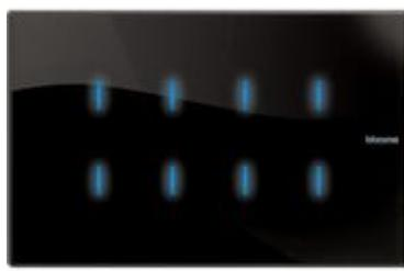
Comando Axolute per gestire carichi singoli o di gruppo (es. luci e tapparelle), diffusione sonora, scenari, funzioni citofoniche base (es. apertura cancelletto). E' dotato di 8 tasti capacitivi, che si azionano a sfioramento, identificabili tramite LED con luce di intensità regolabile.
