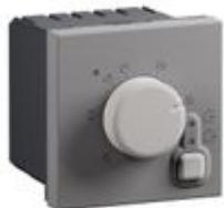
Termostato ambiente elettronico - uscita a relè con 1 contatto in commutazione: 8 A - 250 Vac  $\text{? cos } \varphi = 1 / 2$  A - 250 Vac  $\text{? cos } \varphi = 0,6$  - Frequenza: 50/60 Hz - alimentazione 230 Vac - 2 moduli - grigio
