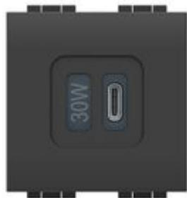
Caricatore USB tipo C per ricarica rapida fino a 30W. Consente la ricarica accelerata di dispositivi portatili (PC, tablet, smartphone) con tecnologia Power Delivery 3.0 e di dispositivi senza Power Delivery 3.0 (tablet e smartphone). Livello di efficienza energetica VI TUV. Consumo in standby 0,06 W. Tensioni di uscita automatiche 5 - 9 - 12-15 - 20 V - 2 moduli.
