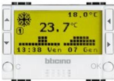
cronotermostato da incasso giornaliero/settimanale per riscaldamento e condizionamento. Tre temperature selezionabili nelle 24 h - Funzionamento auto -manuale - Holiday - antigelo. Display retroilluminato - alimentazione a batterie: 2x1,5 V - teleattivabile attraverso controllo remoto - possibilità di collegamento di una sonda esterna - uscita: contatto in scambio 5(3) A - Bianco
