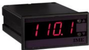
DGP 36 P2k - indicatore digitale programmabile 2000 punti per AC diretta o da TA / tensione alternata diretta o da TV / frequenza di rete / DC bidirezionale diretta o indiretta / tensione continua bidirezionale diretta o indiretta - Formato:72x36mm
