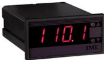
DGP 36 P2k - indicatore digitale per corrente o tensione continua programmabile 2000 punti - Formato:72x36mm - Ingresso: 1/5/10/20mA - 4-20mA - 50/60/75/100/150mV - 1/5/10V - Aux: 80-270Vac/100-300Vdc - Visualizzazione: programmabile (indicazione massima +1999)
