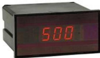
DGP 96 - voltmetro/amperometro digitale per corrente (ingresso da TA) o tensione alternata RMS (ingresso diretto) 1000 punti - Formato: 96x48mm - Ingresso: 5A o 500V - Aux: 150÷250 Vdc - Visualizzazione: 5÷8000A (38 portate selezionabili)/diretta 500 V
