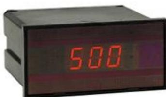
DGP 96 - voltmetro/amperometro digitale per corrente (ingresso da TA) o tensione alternata RMS (ingresso diretto) 1000 punti - Formato: 96x48mm - Soglie: 2 max o 2 min o 1 min + 1 max programmabili - Ingresso: 5A o 500V - Aux: 240Vac - Visualizzazione: 5÷8000A (38 portate selezionabili)
