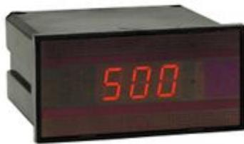
DGP 96 - voltmetro/amperometro digitale per corrente (ingresso da TA) o tensione alternata RMS (ingresso diretto) 1000 punti - Formato: 96x48mm - Soglie: 2 max o 2 min o 1 min + 1 max programmabili - Ingresso: 1A o 500V - Aux: 150÷250 Vdc - Visualizzazione: 5÷8000A (38 portate selezionabili)
