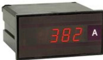
DGP 96 - amperometro digitale per DC unidirezionale (ingresso da derivatore) 1000 punti - Formato: 96x48mm - Ingresso: 60/100/150 mV selezionabili - Aux: 230Vac - Visualizzazione: 5÷8000A (38 portate selezionabili)
