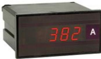
DGP 96 - amperometro digitale per DC unidirezionale (ingresso da derivatore) 1000 punti - Formato: 96x48mm - Soglie: 2 max o 2 min o 1 min + 1 max programmabili - Ingresso: 60/100/150 mV selezionabili - Aux: 115Vac - Visualizzazione: 5÷8000A (38 portate selezionabili)
