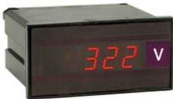
DGP 96 - voltmetro digitale per tensione continua unidirezionale (ingresso diretto) 1000 punti - Formato: 96x48mm - Soglie: 2 max o 2 min o 1 min + 1 max programmabili - Ingresso: 0÷100/0÷500V selezionabili - Aux: 24Vac - Visualizzazione: diretta 0÷99.9/0÷500V
