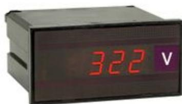
DGP 96 - voltmetro digitale per tensione continua unidirezionale (ingresso diretto) 1000 punti - Formato: 96x48mm - Soglie: 2 max o 2 min o 1 min + 1 max programmabili - Ingresso: 0÷100/0÷500V selezionabili - Aux: 240Vac - Visualizzazione: diretta 0÷99.9/0÷500V
