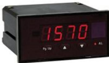
DGP 96 - voltmetro/amperometro digitale per corrente o tensione continua programmabile 2000 punti - Formato: 96x48mm - Ingresso: 50÷200 mV/5÷20 V/50÷200 V/0.5÷2 mA/5÷20 mA/4..20 mA - Uscita: nessuna - Aux: 150÷250 Vdc - Visualizzazione: programmabile
