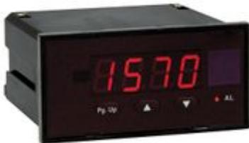
DGP 96 - voltmetro/amperometro digitale per corrente o tensione continua programmabile 2000 punti - Formato: 96x48mm - Soglie: 2 max o 2 min o 1 min + 1 max programmabili - Ingresso: 50÷200 mV/5÷20 V/50÷200 V/0.5÷2 mA/5÷20 mA/4..20 mA - Uscita: nessuna - Aux: 20÷150 Vdc/48 - Visualizzazione: programmabile
