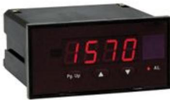
DGP 96 - voltmetro/amperometro digitale per corrente o tensione continua unidirezionale programmabile 10000 punti - Formato: 96x48mm - Ingresso: 50÷200 mV/5÷20 V/50÷200 V/0.5÷2 mA/5÷20 mA/4..20 mA - Uscita: nessuna - Aux: 24Vac - Visualizzazione: programmabile
