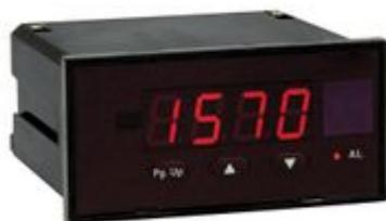
DGP 96 - voltmetro/amperometro digitale per corrente o tensione continua unidirezionale programmabile 10000 punti - Formato: 96x48mm - Ingresso: 50÷200 mV/5÷20 V/50÷200 V/0.5÷2 mA/5÷20 mA/4..20 mA - Uscita: nessuna - Aux: 115Vac - Visualizzazione: programmabile
