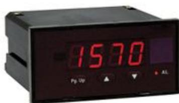
DGP 96 - voltmetro/amperometro digitale per corrente o tensione continua unidirezionale programmabile 10000 punti - Formato: 96x48mm - Ingresso: 50÷200 mV/5÷20 V/50÷200 V/0.5÷2 mA/5÷20 mA/4..20 mA - Uscita: 24 Vdc per alimentazione sensore esterno - Aux: 240Vac - Visualizzazione: programmabile
