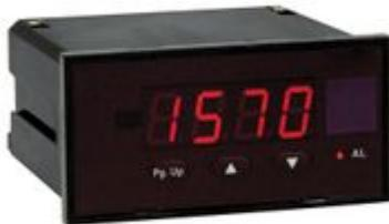
DGP 96 - voltmetro/amperometro digitale per corrente o tensione continua unidirezionale programmabile 10000 punti - Formato: 96x48mm - Ingresso: 50÷200 mV/5÷20 V/50÷200 V/0.5÷2 mA/5÷20 mA/4..20 mA - Uscita: nessuna - Aux: 20÷150 Vdc/48 Vac - Visualizzazione: programmabile
