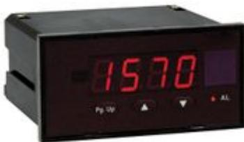
DGP 96 - voltmetro/amperometro digitale per corrente o tensione continua unidirezionale programmabile 10000 punti - Formato: 96x48mm - Soglie: 2 max o 2 min o 1 min + 1 max programmabili - Ingresso: 50÷200 mV/5÷20 V/50÷200 V/0.5÷2 mA/5÷20 mA/4..20 mA - Uscita: nessuna
