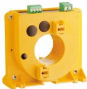
HT35Bs - Trasformatore con trasduttore integrato a effetto Hall (passaggio cavo  $\varnothing$  35mm) - Uscita: 0÷20mA - Corrente: 10/20/30/40/50/60/70/80/90/100A (selezionabile) - Aux: 15Vdc derivata da HT35Bm
