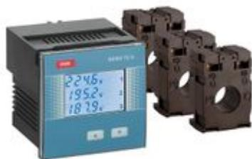
Kit Nemo 72-b + 3 TAIBB 200/5A Multifunzione per applicazione in b.t. - Rete: monofase o trifase 3/4 fili squilibrata - Display: LCD retroilluminato - Formato: 72x72mm - Uscita: nessuna - Corrente: 5A - da TA dedicati 5÷8000A (41 portate primarie selezionabili) - Tensione: 340÷450Vac - Autoalimentato
