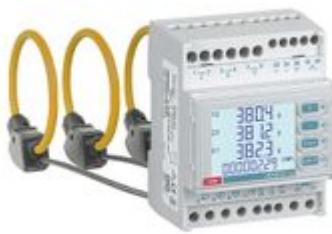
Kit Nemo D4-Le + 3 sensori di corrente Rogowski ø 80mm - Multifunzione per applicazione in b.t. - Rete: monofase o trifase 3/4 fili squilibrata - Display: LCD retroilluminato - Formato: 4 moduli DIN - Uscita: nessuna - Corrente: 5A - da TA dedicati 5÷8000A (41 portate primarie selezionabili) - Uscita: Impulsi S0 / 1 contatto di allarme + RS485 BACnet - Ingresso: 80÷500Vac - Alimentazione ausiliaria: 80÷265Vac o 100÷300Vdc
