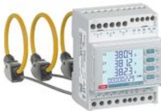
Kit Nemo D4-Le + 3 sensori di corrente Rogowski ø 190mm - Multifunzione per applicazione in b.t. - Rete: monofase o trifase 3/4 fili squilibrata - Display: LCD retroilluminato - Formato: 4 moduli DIN - Uscita: nessuna - Corrente: 5A - da TA dedicati 5÷8000A (41 portate primarie selezionabili) - Uscita: Impulsi S0 / 1 contatto di allarme + RS485 BACnet - Ingresso: 80÷500Vac - Alimentazione ausiliaria: 80÷265Vac o 100÷300Vdc
