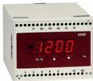
RM3C - Relè di misura per corrente/tensione continua - Formato: retroquadro canalina - Ingresso: 50÷200mV/5÷20V/50÷200V/0.5÷2mA/5÷20mA/4÷20mA - Uscita: 2 relè con contatti SPDT - Aux: 24Vac - Soglie: 2 max o 2 min o 1 min + 1 max programmabili
