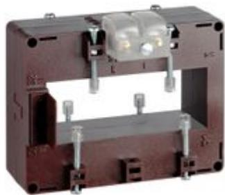
TAS102 - Trasformatore di corrente monofase precisione - Cavo/sbarra passante: 102x38mm - Rapporto: 1200/1A - Classe: 0.2s/0.2/0.5s - Prestazioni: 5/7.5/10VA - morsetti lato lungo (fissaggio su sbarra orizzontale)
