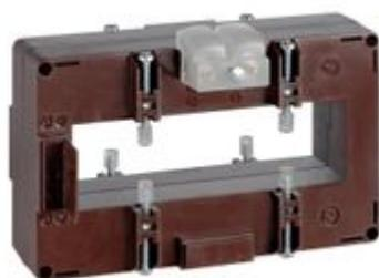
TAS127 - Trasformatore di corrente monofase precisione - Cavo/sbarra passante: 127x38mm - Rapporto: 2500/5A - Classe: 0.2s/0.2/0.5s - Prestazioni: 15/20/25VA - morsetti lato lungo (fissaggio su sbarre orizzontali)
