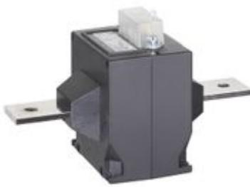
TAQ20P - Trasformatore di corrente monofase per protezione - Cavo/sbarra passante: primario avvolto - Rapporto: 80/5A - Classe: 5P5/5P10 - Prestazioni: 8/4VA
